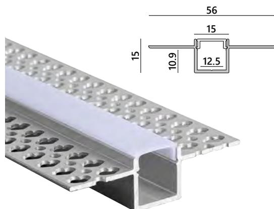
Profilo alluminio per cartongesso con copertura opaca - 2m
