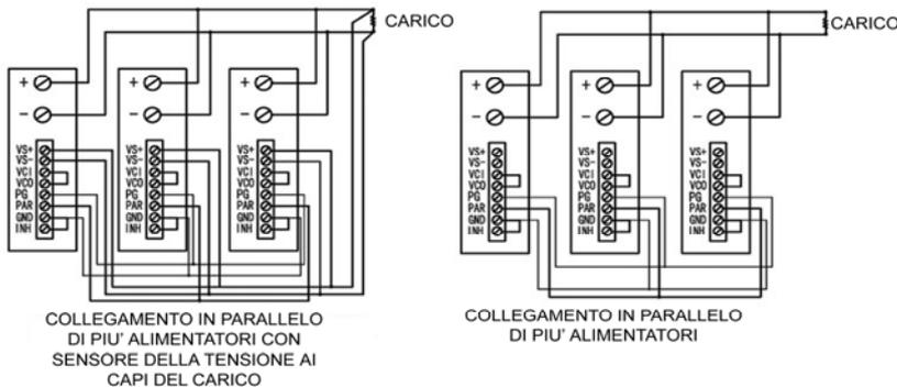
COLLEGAMENTO IN PARALLELO DI PIU' ALIMENTATORI CON SENSORE DELLA TENSIONE AI CAPI DEL CARICO
