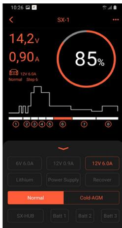
Per far partire la carica, selezionare il tipo di carica desiderata (6V, 12V-0.9A, 12V-6.0A, Lithium, Power Supply oppure Recover).
