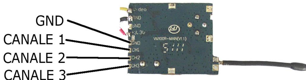
**MODIFICA DEL CANALE DI TRASMISSIONE DEL TRASMETTITORE:**
