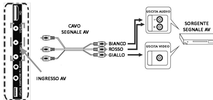
Seguendo l'esempio della figura qui sopra, collegare i connettori RCA del cavo segnale AV all'ingresso AV del monitor, avendo cura di rispettare i relativi colori: connettore **giallo** per il segnale video, connettore **bianco** per il canale sinistro del segnale audio e connettore **rosso** per il canale destro del segnale audio.
