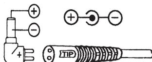
Se l'ingresso del dispositivo da alimentare ha **polarità negativa centrale**, prendere in mano il cavo d'uscita dell'AP924W e individuare la scritta "TIP". Prendere il connettore prescelto, individuare il segno - e inserire il connettore prestando molta attenzione che la scritta "TIP" e il segno - combacino.
