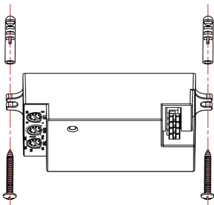
Fissaggio del sensore
