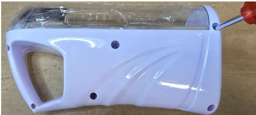
2. Svitare le due viti che fissano la batteria e scollegare il connettore dalla scheda elettronica:
