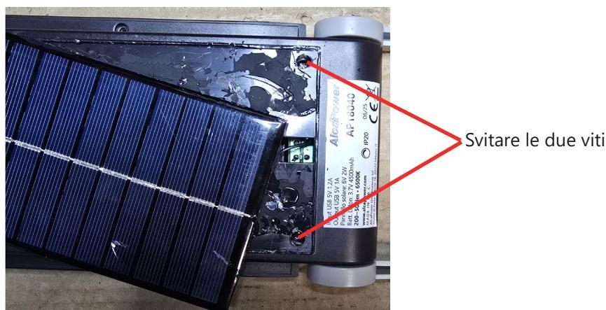
4. Scollegare il connettore batteria dalla scheda elettronica e sostituire la batteria con equivalente:
