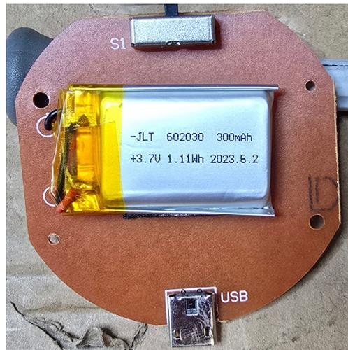
3. Dissaldare i due fili rosso e nero della batteria, prestando attenzione a non fare cortocircuito, e sostituire la batteria con equivalente:
