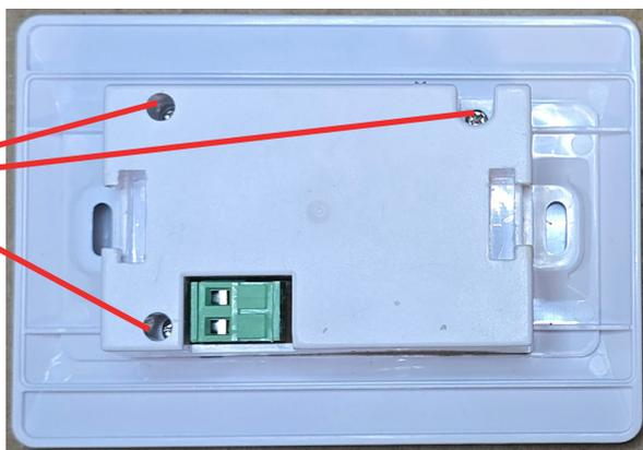
2. Rimuovendo il coperchio posteriore si ha accesso alla batteria: dissaldare i fili rosso e nero dai poli della batteria, prestando attenzione a non fare cortocircuito:
