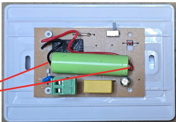
3. Rimuovere la batteria esausta e sostituirla con equivalente:
