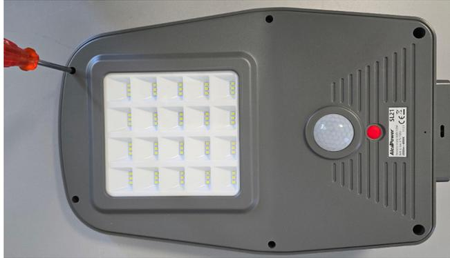
2. Separare le due parti per avere accesso all'interno dopodichè rimuovere lo spessore adesivo nero, facendo attenzione a non danneggiarlo poichè andrà rimosso una volta sostituita la batteria:
