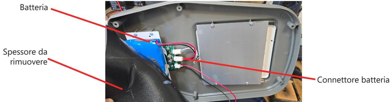
3. Scollegare il connettore della batteria dalla scheda elettronica e rimuovere l'adesivo con cui è fissata la batteria utilizzando un cacciavite di plastica; prestare attenzione a non danneggiare o forare la batteria.
