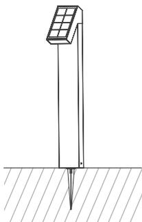
1. Avvitare e fissare il paletto da terreno al proiettore.
