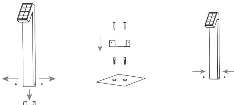
1. Staccare la staffetta di fissaggio nella parte inferiore del proiettore svitando le due viti laterali di fissaggio.
