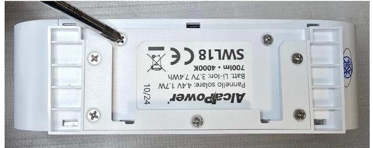
2. Facendo leva con un cacciavite a taglio, sollevare leggermente il proiettore dal corpo dopodichè far passare un cacciavite di plastica lungo tutto il perimetro per separare completamente i due pezzi proiettore-corpo:
