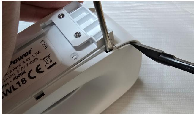
3. Svitare le quattro viti di fissaggio del vano batteria per avere accesso alla batteria da sostituire:
