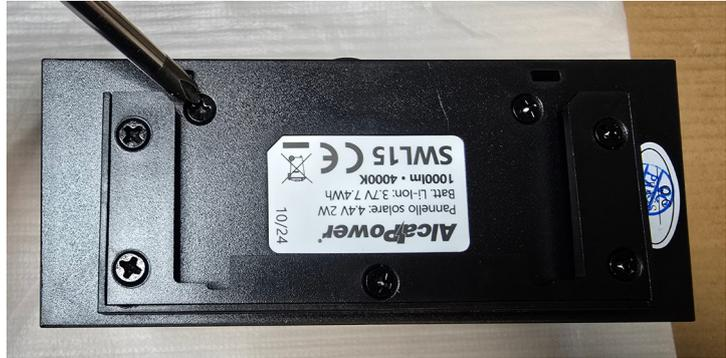
2. Sollevare leggermente il proiettore dal corpo dopodichè far passare un cacciavite di plastica lungo tutto il perimetro per separare completamente i due pezzi proiettore-corpo:
