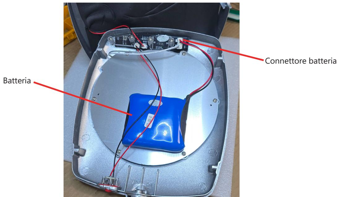
3. Scollegare il connettore della batteria dalla scheda elettronica e rimuovere l'adesivo con cui è fissata la batteria utilizzando un cacciavite di plastica; prestare attenzione a non danneggiare o forare la batteria.
