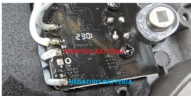
4. Scaldare con un phon e rimuovere delicatamente la protezione di plastica adesiva nera (prestare attenzione a non danneggiarla poichè andrà rimessa dopo aver sostituito la batteria).
