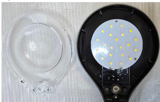
3. Svitare le due viti che fissano la scheda LED e sollevarla per avere accesso alla scheda inferiore. Individuare i due fili della batteria contrassegnati dalle piazzole "B+" e "B-" e dissaldarli prestando attenzione a non fare cortocircuiti.
