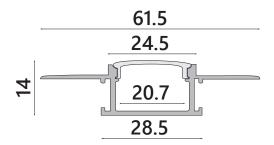
Compatibile con le strisce LED COB 220V e LED COB SURFACE 25W.
