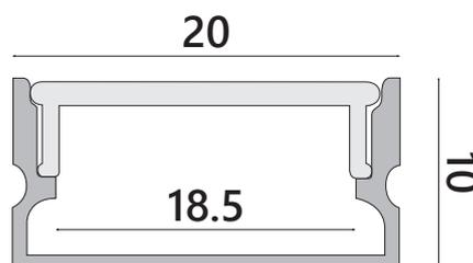
**Compatibile con le strisce LED COB 220V, LED COB SURFACE 25W e LED COB 15W.**
