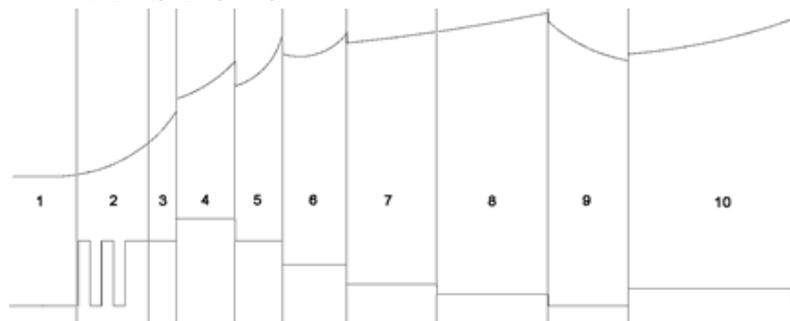
Il diagramma qui sopra rappresenta in maniera generica le varie fasi di carica di una batteria. Grazie al suo microcontrollore, CLX-2 autoregola queste fasi in base alle caratteristiche della batteria.
